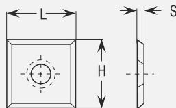
Nož se koristi na glavama i nadstolnim glodalima za obradu punog drva i oplemenjenih materijala. Ima oštricu s 4 strane.
