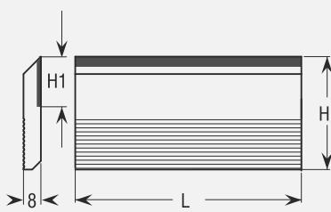
Nož nazubljeni u HW kvaliteti (debljine 8 mm), dostupan ravnii profilirani u raznim dimenzijama. Koristi se na glavama T206, T206Hi i T206W za obradu punog drva i MDF-a.
