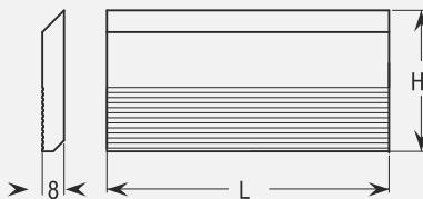
Nož nazubljeni u HS kvaliteti (debljine 8 mm), dostupan ravnii profilirani u raznim dimenzijama. Koristi se na glavama T206, T206Hi i T206W za obradu punog drva.
